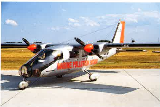
Abb. 4: Die speziell für Beobachtungszwecke gebaute zweimotorige Partenavia Observer eignet sich besonders gut für Zählungen von Kleinwalen.
