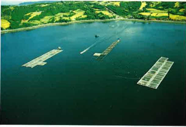
Abb. 3: Netzkäfige zur Salmonidenzucht in zweireihigen Blöcken quer zur Gezeitenströmung angeordnet.
