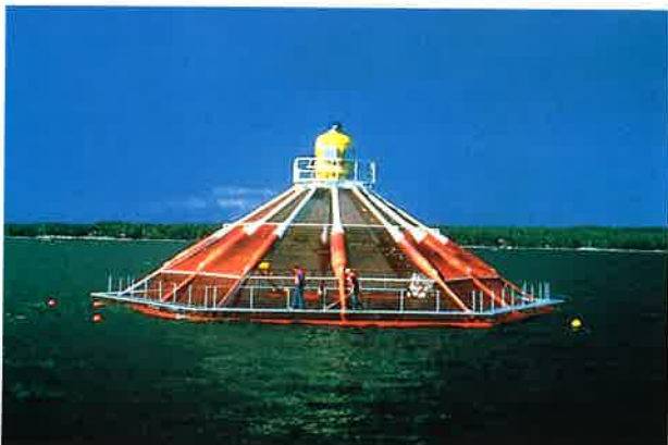
Abb. 4: Moderner „Offshore“-Käfig (sog. „Farm-Ocean“-Käfig). Eine Entwicklung, die von geschützten und damit ökologisch empfindlicheren Standorten unabhängig wird.
