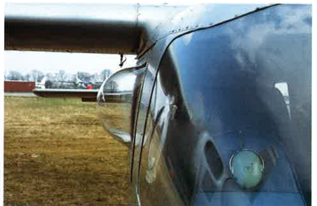
Abb. 5: Das „Bubble Window“ ermöglicht dem Beobachter einen reflexionsfreien Blick senkrecht nach unten auf die Transektlinie.
