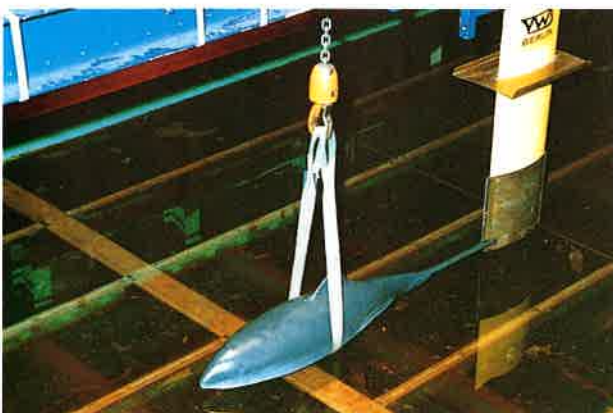
Abb. 4: Versuchsvorbereitung für Widerstandsmessungen im Wasserkanal
