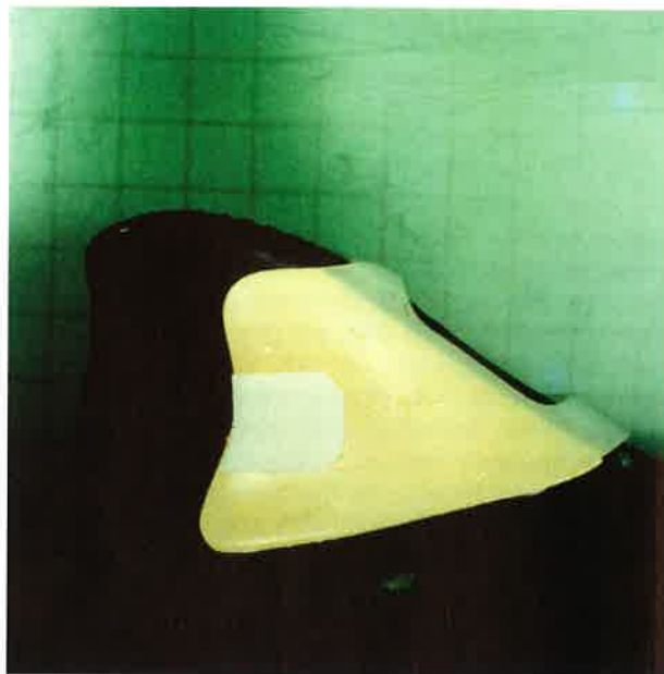
Abb. 3: Eine von Dr. F. Townsend entwickelte Telemetrie-geräthalterung, die mittels Saugnäpfen an der Rückenfinne von Schweinswalen befestigt wird. Sie ermöglicht ein schnelles Anbringen und verzichtet auf das sonst übliche Durchbohren der Rückenfinne.
