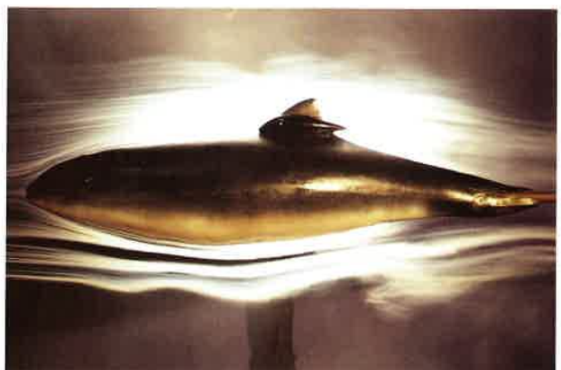
Abb. 2: Schweinswalmodell mit Senderatrasse im Rauchwindkanal, Anströmgeschwindigkeit 6 m/s.
