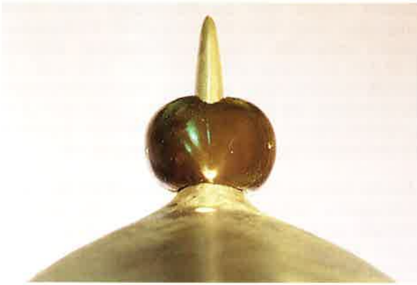
Abb. 3 a, b: An einem Tierkörpermodell im Rauchwindkanal strömungsdynamisch optimierte Form eines Telemetrie-gerätes zur Befestigung an der Rückenfinne von Schweinswalen (verschiedene Ansichten).
