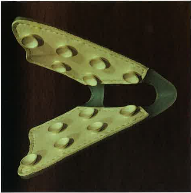
Abb. 4: Blick auf die Innenseite der von Dr. F. Townsend entwickelten Telemetrieerätehalterung mit den Saugnäpfen. Bei Versuchen mit Großen Tümmlern und Schweinswalen in den USA blieb diese Halterung bis zu vier Wochen an den Tieren.
