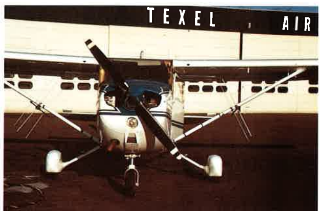
Abb. 17: Cessna mit an beiden Flügelstützen montierten Richtantennen für flächendeckende Peilflüge.
