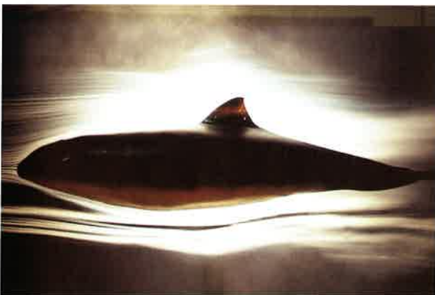
Abb. 1: Abgußmodell eines Schweinswales im Rauchwindkanal, Anströmgeschwindigkeit 6 m/s.
