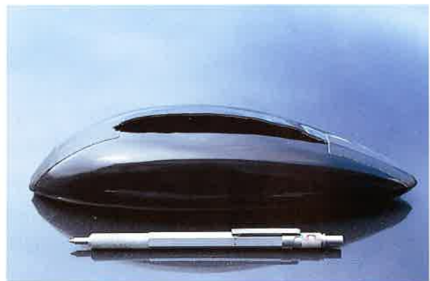
Abb. 5: Als Ergebnis von zahlreichen Tests im Wind- und Wasserkanal wurde von Dr. Bannasch diese Gehäuseform für den Einsatz von Satellitensendern und TDR's an Schweinswalen entwickelt (s. folgenden Beitrag).
