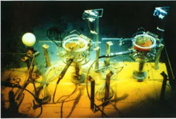
Abb. 9: Mit Sauerstoffmeßkammern, die außen am Forschungstauchboot GEO montiert waren, konnte im Lebensraum die Photosynthese der Zooxanthellen in Leptoseris fragilis gemessen werden (Aufnahme aus dem Forschungstauchboot GEO).
