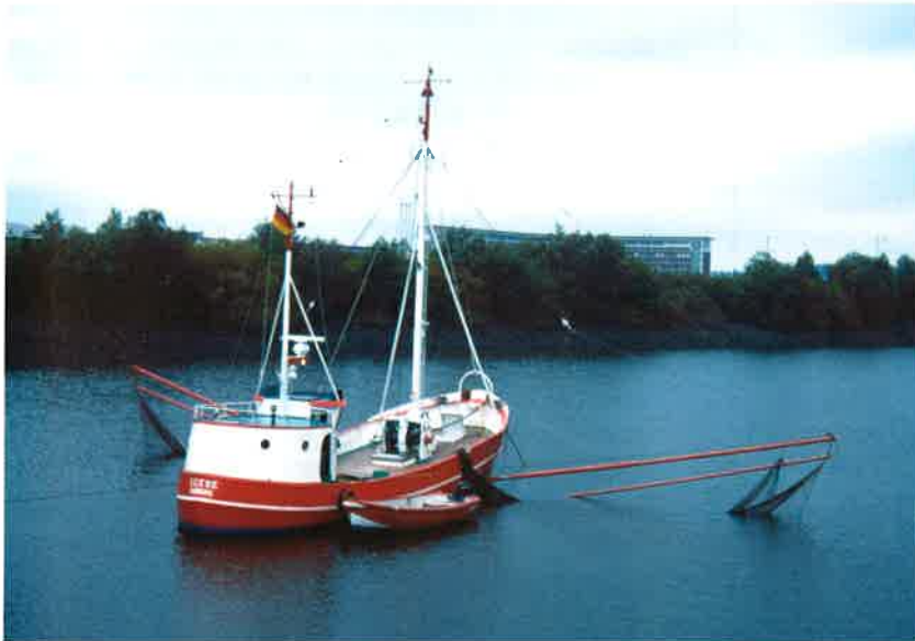
Abb. 6: Hamenkutter im Elbeästuar mit gehieften Hamennetzen. Neben Baumkurren gehören Hamen zu den am häufigsten in den Nordseeästuaren eingesetzten kommerziellen Fanggeräten. Zum Fang wird das Schiff verankert, und die beidseitig vorhandenen Hamennetze werden in die Flut- bzw. Ebbströmung exponiert.
