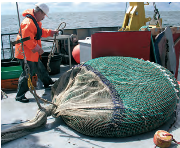
Abb. 7: Forschungsfischerei mit GÖS „Strelasund“. Der mit Fischen gefüllte Steert eines Forschungsstrawls wurde an Bord gehievt.
