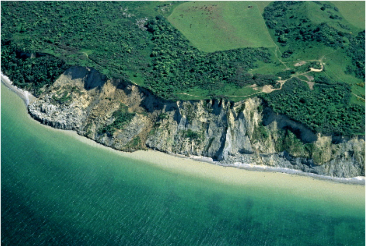
Abb. 12 : Frische Hangabbrüche an der Nordwestküste der Insel, dem so genannten „Toten Kerl“. Im April 2000 und Mai 2000 rutschten dort jeweils etwa 60 000 m 3 Sand und Geschiebemergel ab.
