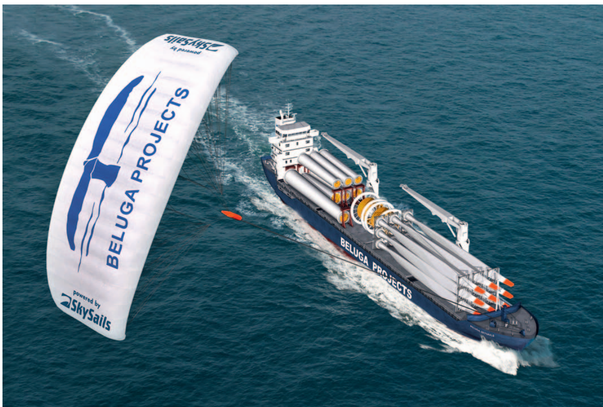
Abb. 8: Neuartige Segel in Form von Lenkdrachen versprechen, bis zu 35 Prozent der Treibstoffe bei Schiffsmotoren einzusparen und so den Ausstoß an CO 2 -Gasen zu verringern. Die Bremer Reederei Beluga Group ließ für die Ausstellung ein Modell des MS BELUGA SKYSAILS im Maßstab 1:50 fertigen.
