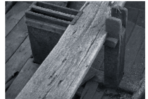
Abb. 20: Das Bootsinnere – sichtbar ist der Schwertkasten mit zwei Kammern und der Mastkoker.
