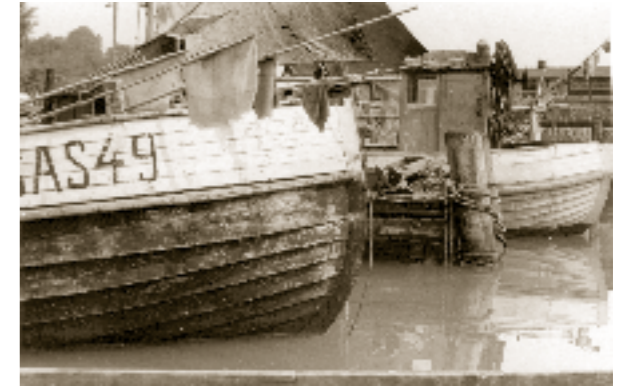
Abb. 8: Vordersteven des Kutters SAS 49, der nach dem Vorbild des aus Schweden stammenden SAS 70 gebaut wurde.
