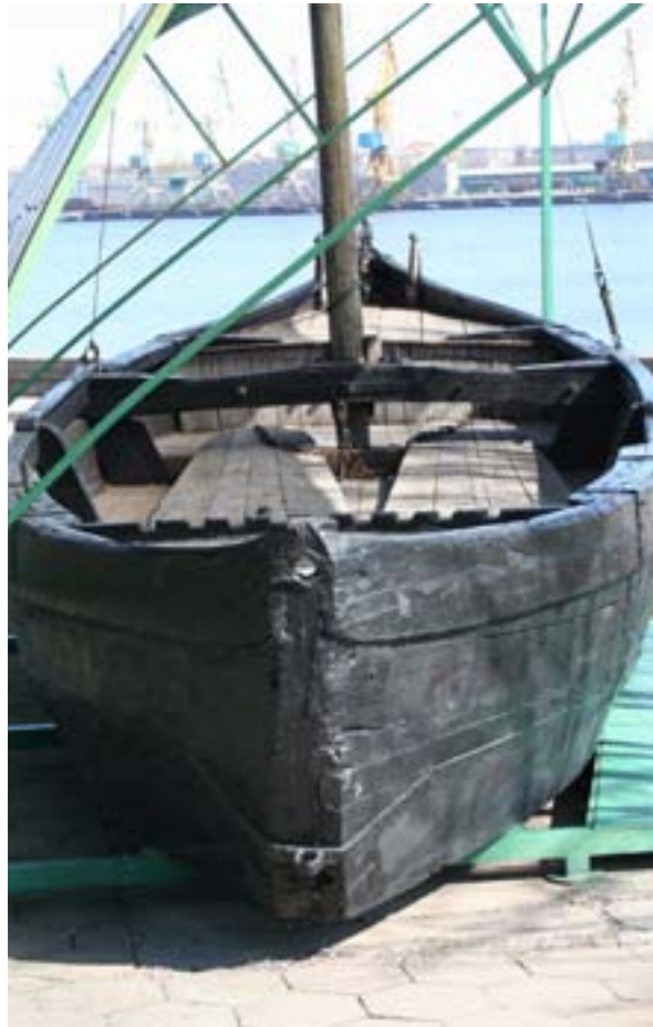
Abb. 5: Der Kurenkahn NID 1 wurde um 1935 in Nidden/Nida gebaut und 1989 restauriert (Länge: 10,8 Meter; Breite über alles: 3,3 Meter; Masthöhe: 10 Meter).
