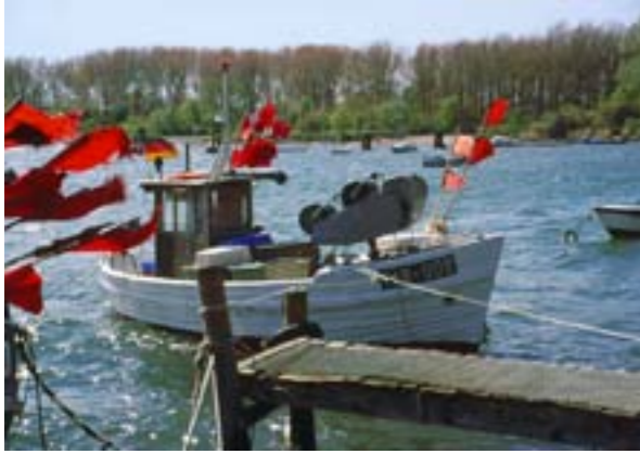
Abb. 2: Kleinkutter TAR-008 mit Netzholer und Plastikrohr als Aussetzhilfe für Stellnetze (Tarnewitz, 1999).
