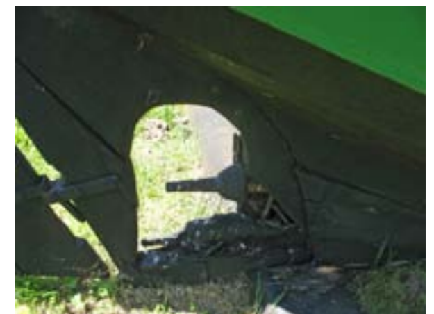
Abb. 8: Jahrzehntelange Lagerung im Freien und nicht sachgerechte Pflege haben den Booten der Freilichtausstellung in Göhren zugesetzt. Die Folgen zeigen sich deutlich bei einem offenen Motorboot (1953 in Thiessow gebaut), das mit einem 11-PS-Junkers-Dieselmotor ausgerüstet war.
