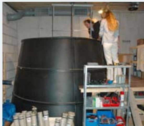
Abb. 36: Für die Kalibrierung der Schweinswal-Horchgeräte (PODs, links vorne) wurde ein großer Messtank mit den entsprechenden Geräten aufgestellt.
