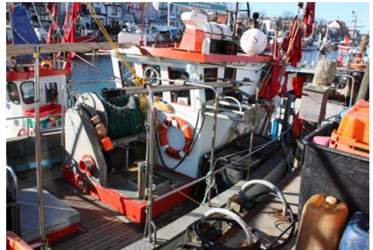
Abb. 1: Hölzerner 12-Meter-Kutter WAR-6 PREROW mit nachgerüsteter Technik. Im Bild backbord der Netzklarer („Rappeler“), steuerbord die Schleppnetztrommel und auf dem Ruderhaus eine Furuno-Radarantenne (Warnemünde, 2011).
