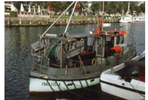
Abb. 5: 9,5-Meter-GFK-Kutter WAR-9 FRANZISKA, erbaut 1995 in Sakskøbing/Dänemark für A. Harant, mit 2005 in Rødvig/Dänemark nachgerüstetem Schleppgeschirr (Warnemünde, 2006).
