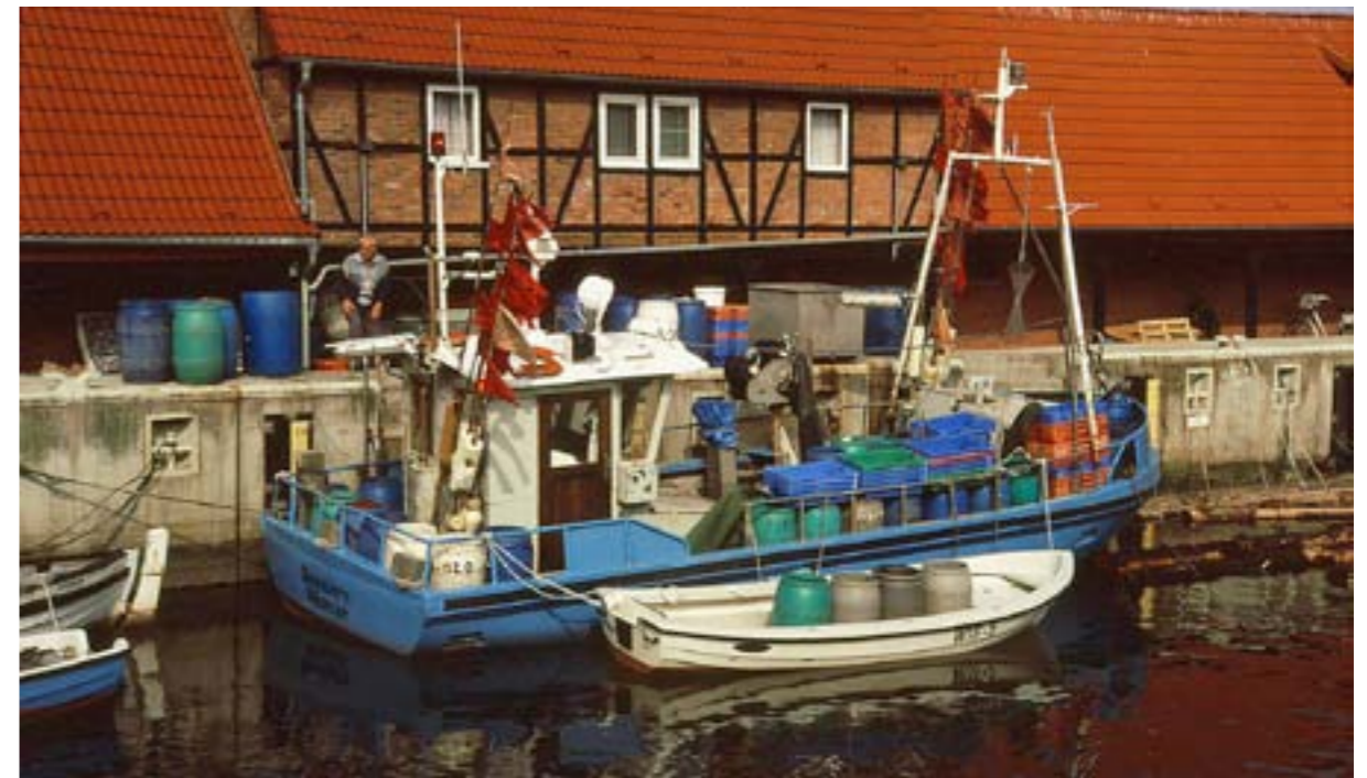
Abb. 8: WIS-020 SEESTERN, eines der ehemals genossenschaftlichen GFK-Boote von der Rechliner Bootswerft, am sanierten Fischereianleger. An Deck u. a. ein zweiter Fahrstand, ein dänischer Netzholer und zahlreiche Fässer zur Aufbewahrung von Stellnetzen (Wismar, 2006).
