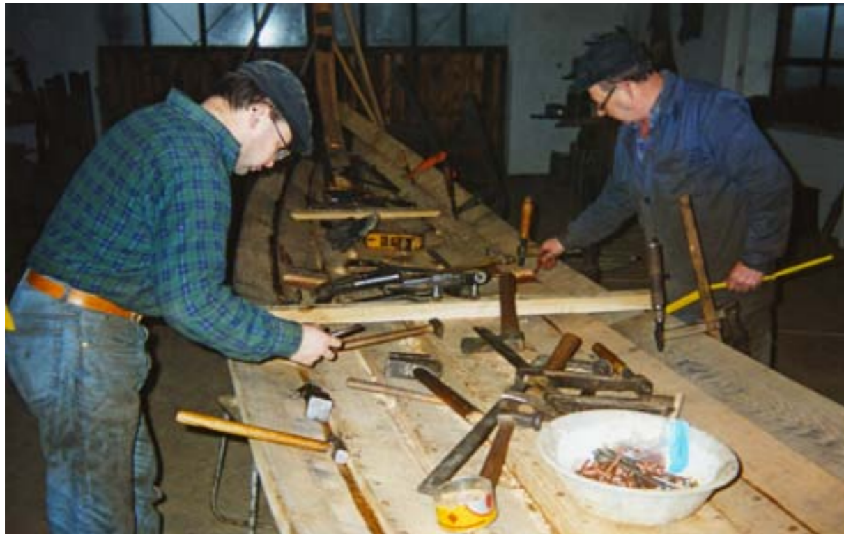
Abb. 12: Montage der Bodenplanken an einem kaschubischen Boot in der Werkstatt von J. Struck (rechts). Sichtbar ist das an der oberen Kielfläche befestigte Brett, das die Formung eines flachen Bodens mittschiffs ermöglicht.
