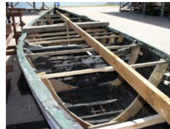
Abb. 5: Zur Vorbereitung des Nachbaus wurden die Maße des Zempiner Heuers mittels Spantmallen abgenommen.
