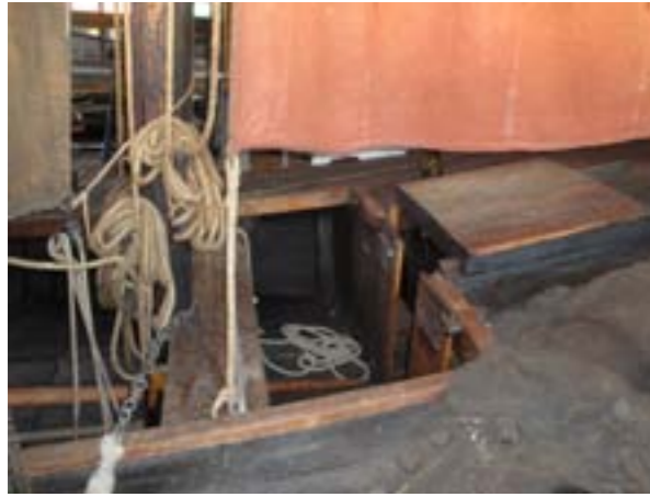
Abb. 8: Vörrunner und Schwertgang auf der STR-9.
