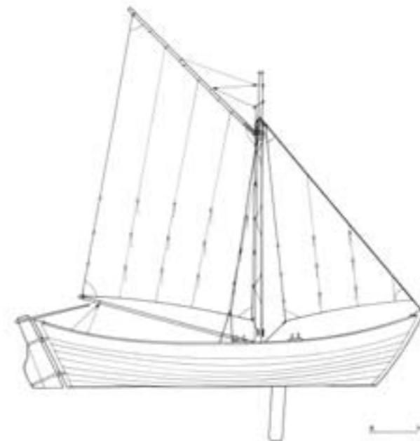
Abb. 6a und b: Konstruktionszeichnung und Takelriss der pomeranka DEB. 5.
