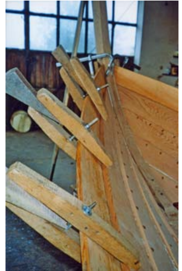
Abb. 13: Befestigen der Plankengänge am Vorstevens in der Werkstatt von J. Struck. Erkennbar sind die Schraubzwingen, die an einer Leiste auf der inneren Vorstevensseite befestigt werden. Der obere Backbord-Plankengang ist mit hölzernen Klammern an den darunter liegenden geheftet.
